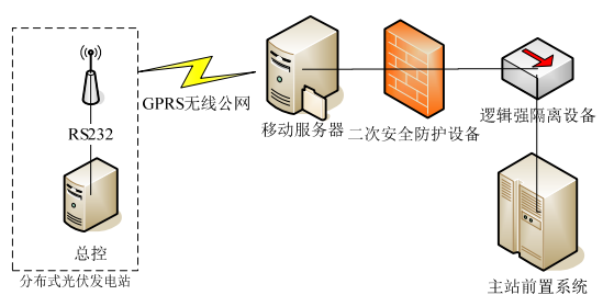
图4 无线公网接入模式结构简图
